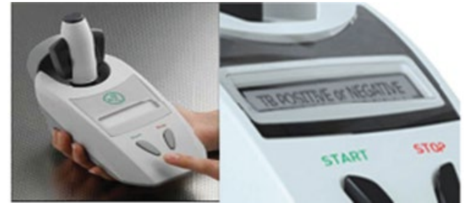
Şekil 1- TB Breathalyzer biyosensörü
