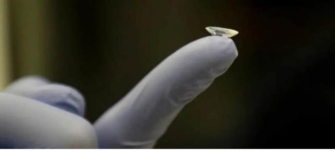
Şekil 6: 3 Boyutlu biyoyazıcı teknolojiyle üretilen yapay kornea
