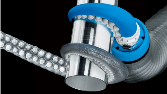
Şekil 1. Ahtaptan esinlenilerek üretilen robotik kol
